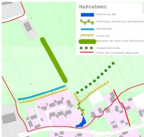
Zur Verbesserung der Abflusssituation wurde das bestehende Regenrückhaltebecken deutlich vergrößert. Sein Fassungsvermögen wurde von ca. 365 m<sup>3</sup> auf 700 m<sup>3</sup> erhöht. Voraussetzung dafür war die Anpassung der Form des Beckens und die Neuerrichtung des vorhandenen Drosselbauwerkes zur Abflussverzögerung. Dieses reguliert den Ablauf des gestauten Wassers über die anschließende Ablaufleitung in den Diethensdorfer Bach.
